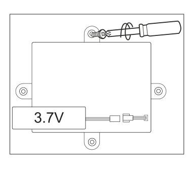
Use a 3.7V lithium battery 使用1个3.7V锂电池
